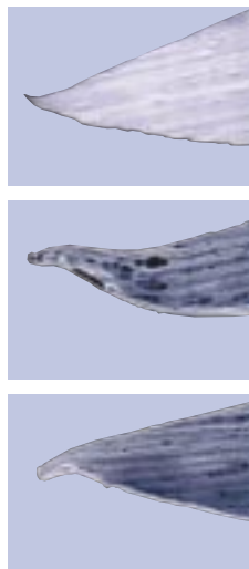
Abb. oben: Veränderung verschiedener im Handel befindlicher Kanülen nach der ersten Injektion
